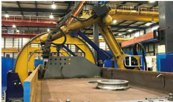
図6 柱大組立溶接ロボットシステムによる梁溶接
