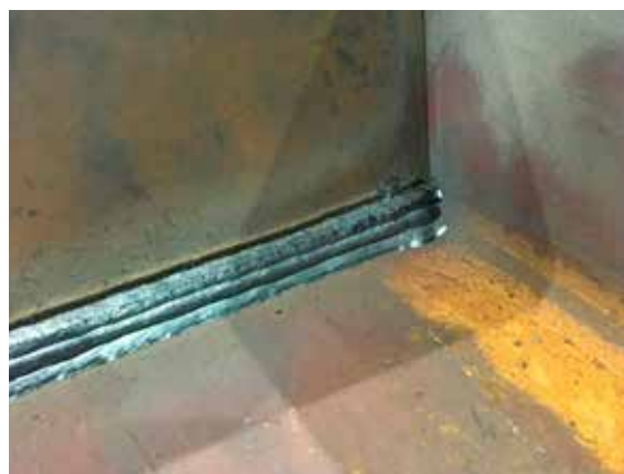
図4 開先付きすみ肉フラックス入りワイヤ溶接ビード外観
