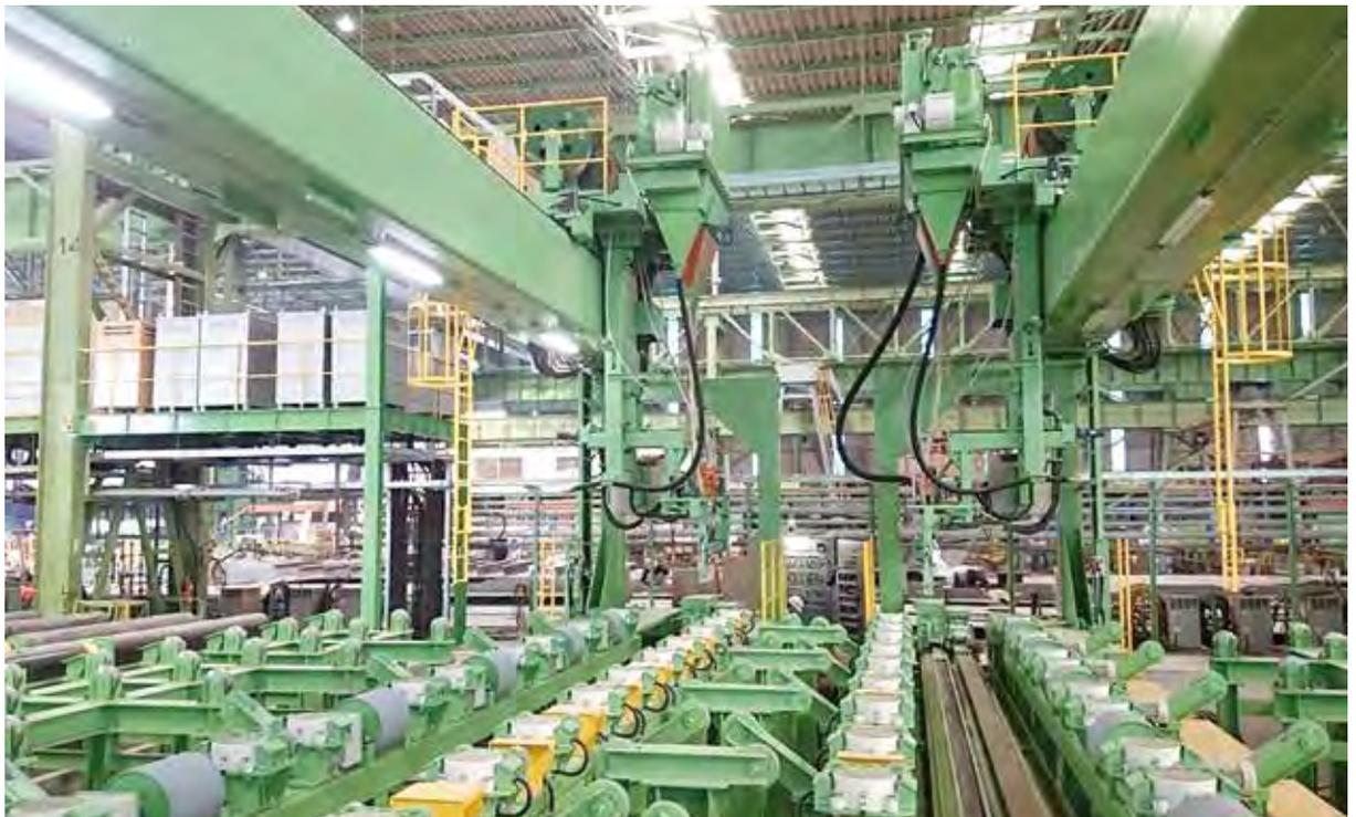
図1 片面溶接装置
