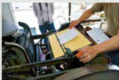
紙を置く部分と版を置いた部分が、二枚貝のような格好で開いては閉じる動作を繰り返す。この位置に手差しで次々と用紙を差し込むことによって、連続印刷していく。
