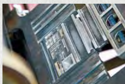
わずかな印圧を調節するために、活字1文字分の大きさに切りぬいた薄紙を版の裏側に挟み込むことも。
