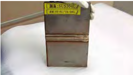
画像② 母材と溶接部の磁性確認
