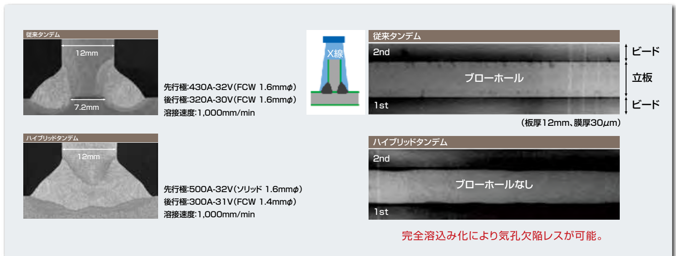
図16 ハイブリッドタンデムマグプロセスによる溶込み形状およびX線像
