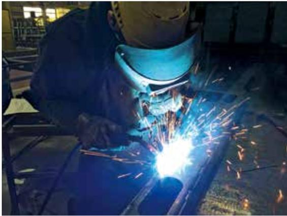
図8 バスのフレーム部品溶接例
