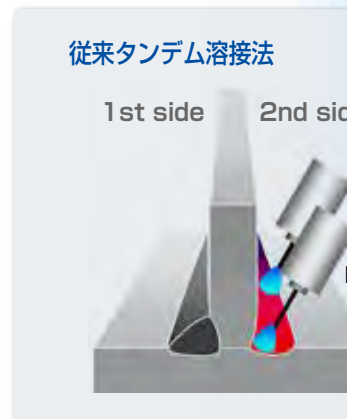
図14 従来タンデム溶接法とハイブリッドタンデム溶接法の比較
