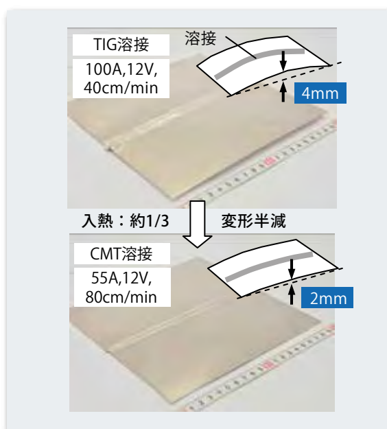
図2 アルミ薄板（1.0mm t ） 突合せ溶接（継手の変形比較）
