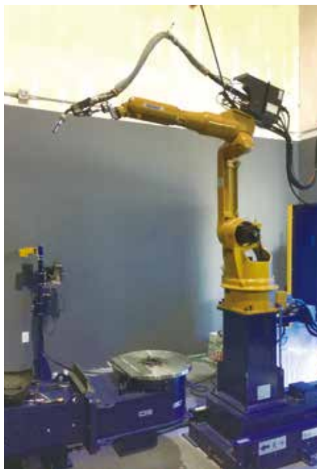
KWAデモ用溶接ロボットシステム
