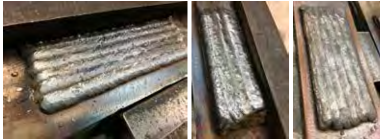
写真3 F SE-50T 下盛溶接 ハーフラップ例
