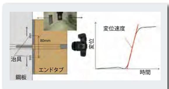
図5 継手終端部の変位速度測定方法<sup>5)</sup>
