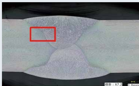
図3 二相ステンレス鋼溶接部のマクロ組織 (赤枠部は解析範囲)
