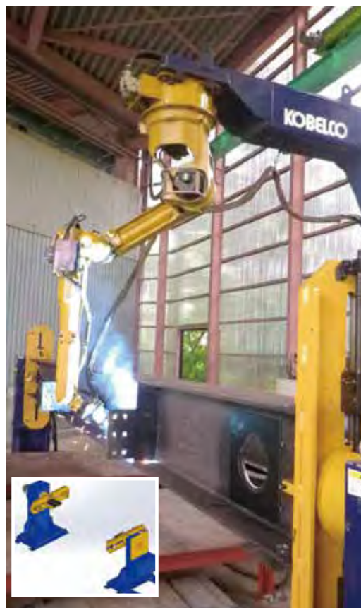
図9 鉄骨梁溶接システム
