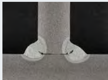
ビード断面写真(ブローホール)
