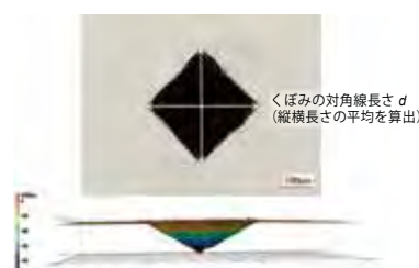
図6 ビッカース硬さ試験の圧痕
