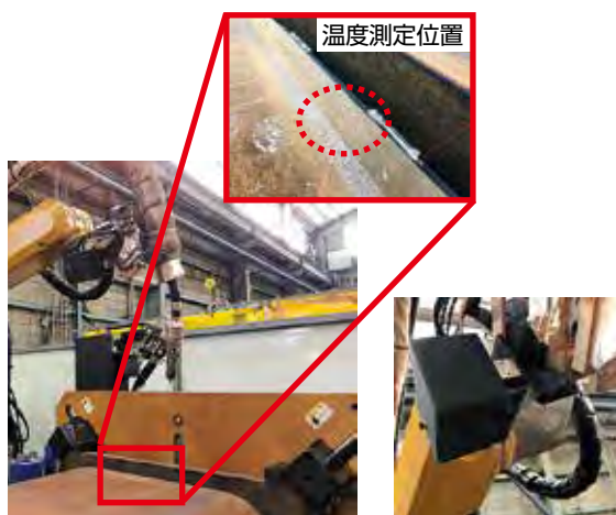
パス間温度センサ測定動作 (コラム溶接) *2)
