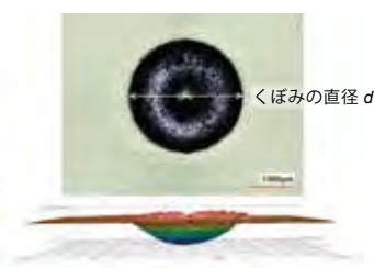
図5 ブリネル硬さ試験の圧痕
