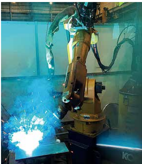
REGARC™ 仕口溶接
