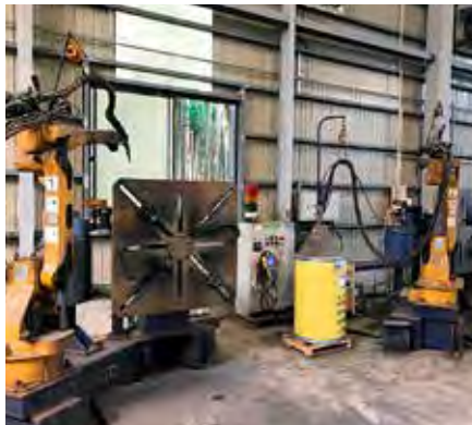
省スペース型鉄骨コア・仕口兼用溶接システム
