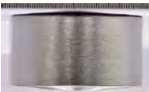
図13 側曲げ試験結果(無欠陥)
