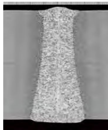
図8 断面マクロ (板厚80mm, ルートギャップ12mm)
