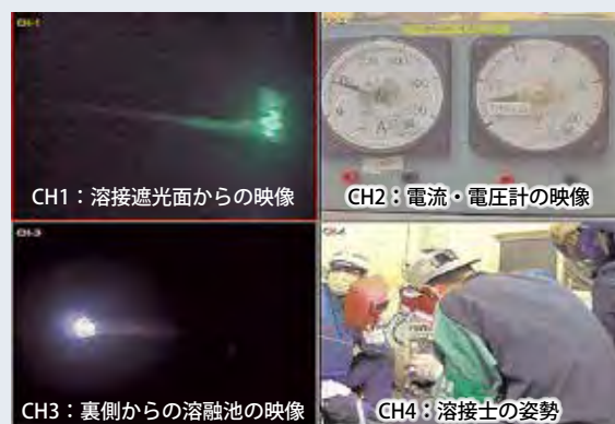
写真1 複数ビデオ撮影による溶接状況
