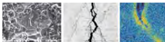
腐食割れの様相 応力腐食割れ特有の亀裂 硫黄のカラーマップ分析 SEMなどによる損傷観察の例
