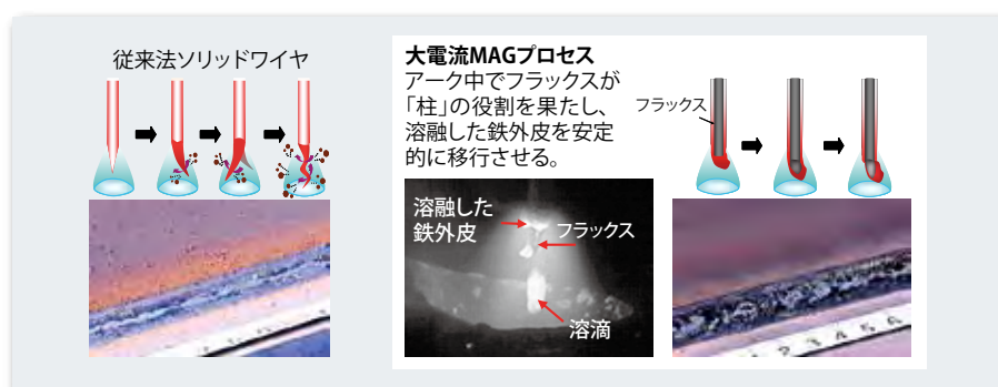
図7 大電流MAGプロセス
