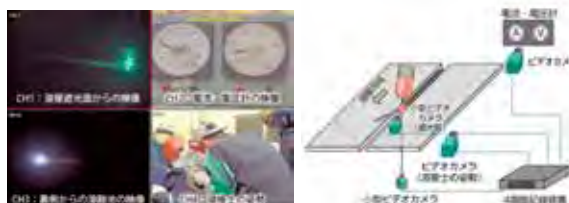
複数ビデオ撮影による溶接状況と撮影システム概要
