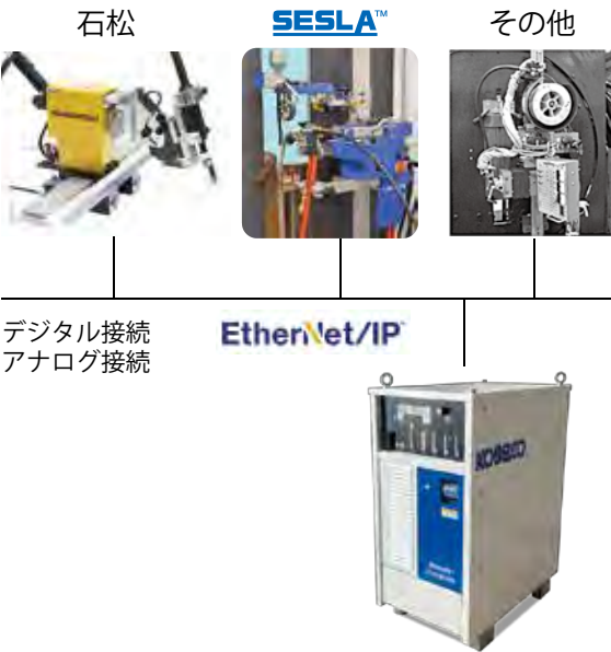
図16 自動溶接機との接続
