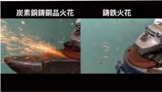
動画2 炭素鋼鑄鋼品と鑄鉄の火花比較
