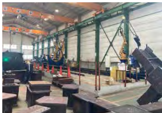
REGARC™ 搭載 鉄骨柱大組立溶接ロボットシステム（シングル）
