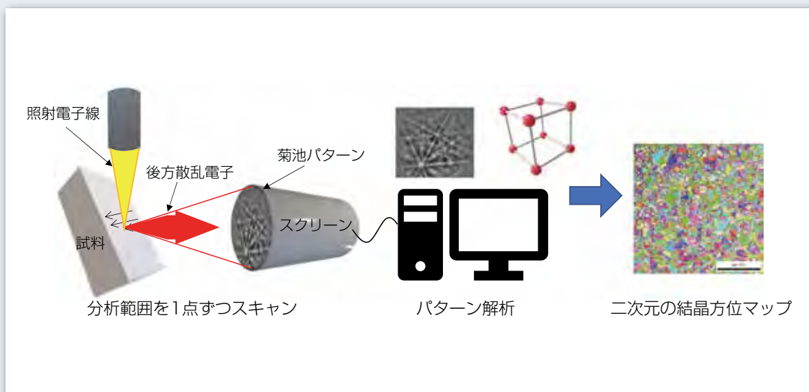
図4 EBSD法の仕組み
