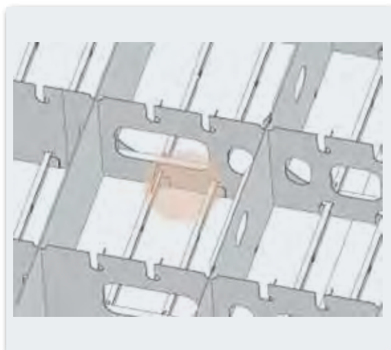
図2 ロボット溶接箇所
