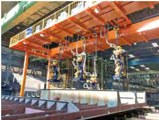
図5 大組立溶接ロボットシステム全景
