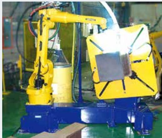
省スペース型鉄骨コア・仕口兼用溶接ロボットシステム
