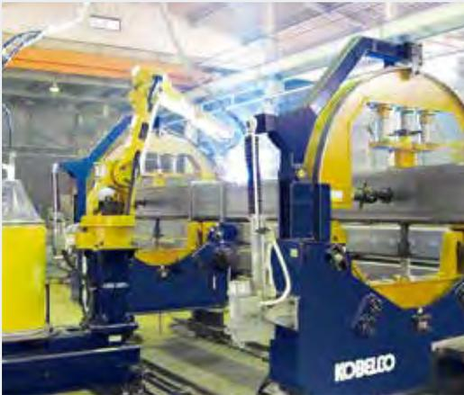
鉄骨柱大組立溶接ロボットシステム
