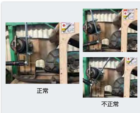
写真9 コンジットホルダーの正しい取り付け方
