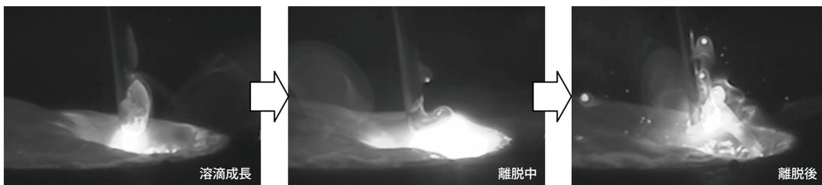
図5-1 340A電流領域における **REGARC™** プロセスの溶滴移行形態
