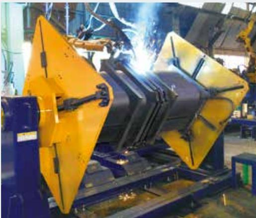
鉄骨コア連結溶接ロボットシステム
