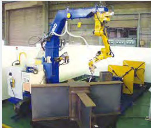
鉄骨天吊マルチワーク溶接ロボットシステム
