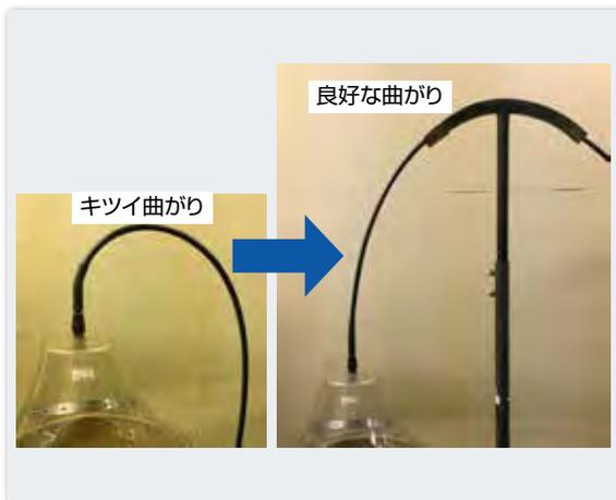
写真8 コンジットチューブの曲がり
