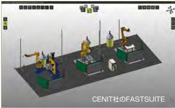
図14 デジタルツイン/実演ブースのシステム動作をリアルタイムで再現
