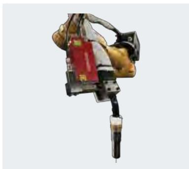
図6 レーザセンサ外観
