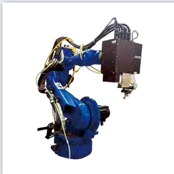
図4 スキャナー搭載溶接ロボット
