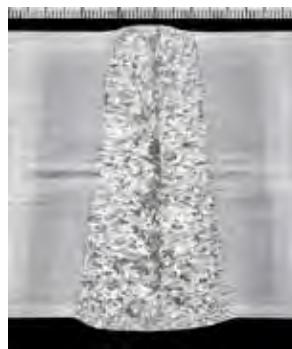
図3 板厚80mmにおける溶接継手の断面マクロ
