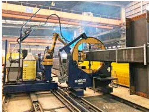
鉄骨柱大組立溶接ロボットシステム
