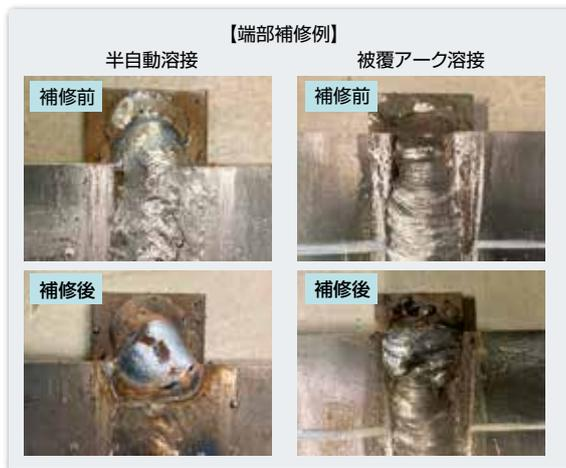
写真3 部分的な補修例
