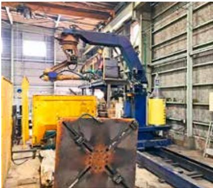
鉄骨天吊マルチワーク溶接システム
