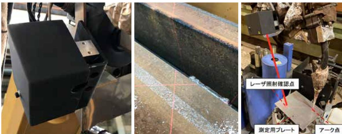
図2 パス間温度測定時の様子
