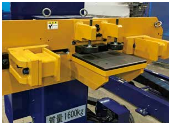
図3 梁専用ポジショナによるワーククランプ
