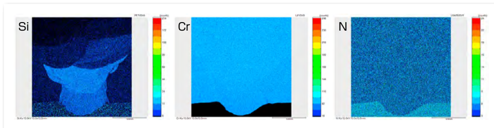
図5 ルート部近傍のSi, Cr, NのEPMAマッピング(立向)
