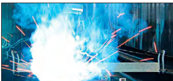
定電圧溶接時のスパッタ飛散状況
