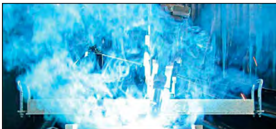
NEW REGARC™ のスパッタ飛散状況
