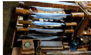
削りの道具、セン。カーブの形状が異なるものを使い分ける
