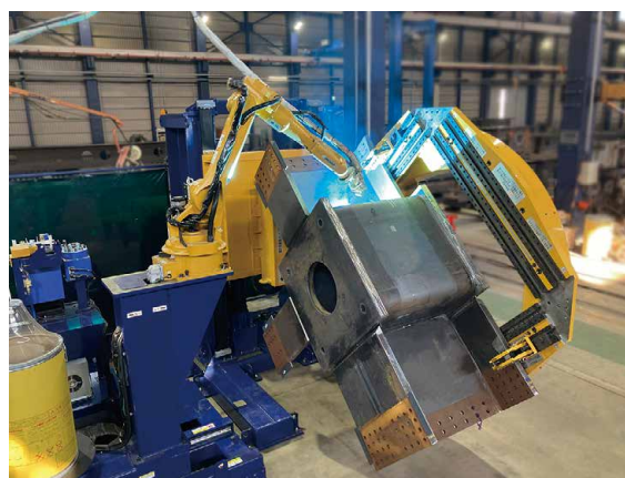
図7 仕口ウェブ溶接姿勢
