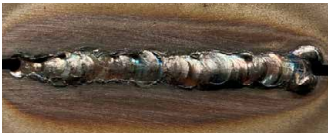
写真4 キーホールが大きき過大となった裏波ビード外観一例
