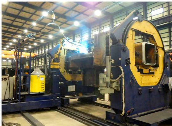
鉄骨柱大組立溶接ロボットシステム（白糸工場）
