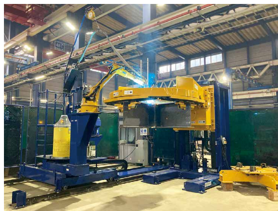
図6 仕口うら面の突合せ溶接姿勢
