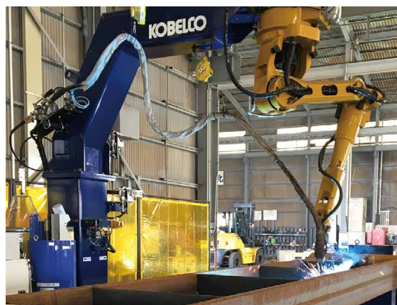
図3 天吊梁溶接ロボットシステム
