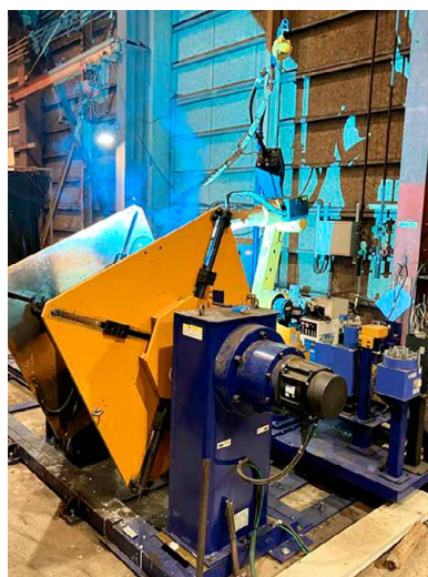
鉄骨コア連結溶接ロボットシステム（第三工場）
