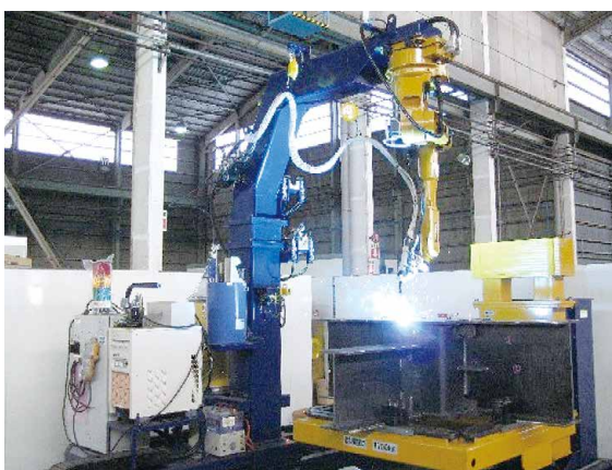
図5 天吊反転仕口溶接ロボットシステム
