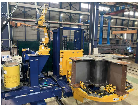
図1 反転仕口・コア兼用溶接ロボットシステム
