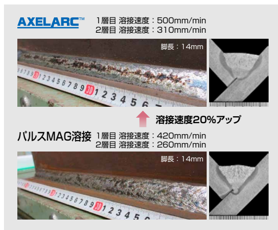
図8 下向きすみ肉溶接における能率向上一例
