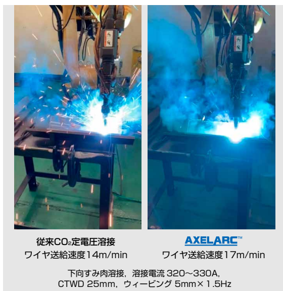
図5 スパッタ飛散状況（下向きすみ肉溶接）【動画】
