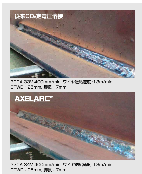
図4 下向すみ肉溶接における母材へのスパッタ付着比較
