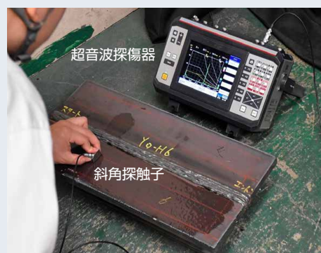
図1 超音波探傷試験の実施状況
