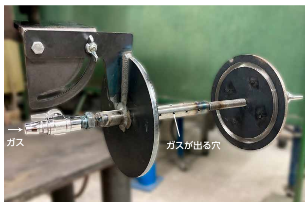
自作の管用バックシールド用治具一例
