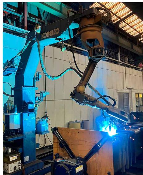
鉄骨天吊マルチワーク溶接ロボットシステム
