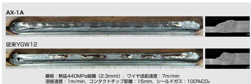
図3 重ね継手溶接時のビード外観および断面マクロ写真
