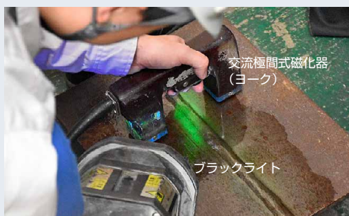
図3 磁粉探傷試験の実施状況
