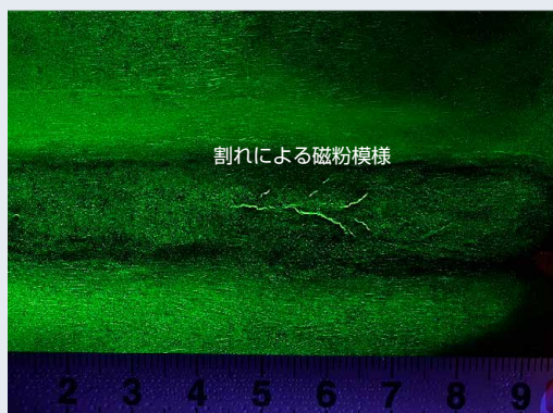
図4 蛍光磁粉によるきず部の磁粉模様
